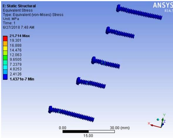
Fig. 5 (d) Von-Mises stress distribution in all screws
