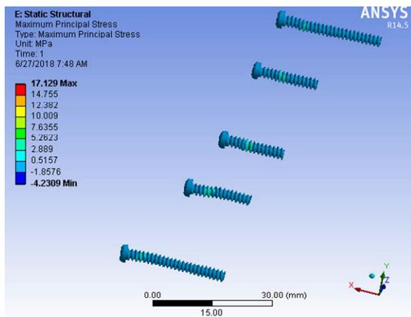
Fig. 6 (d) Maximum principal stress in all screws
