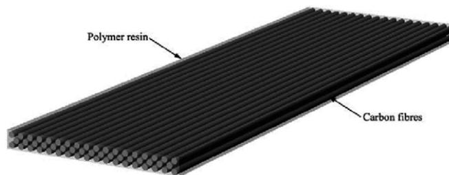
Fig. 6 CFRP
